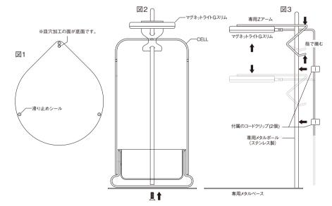
付属の皿ネジで接続し組み立てます。
